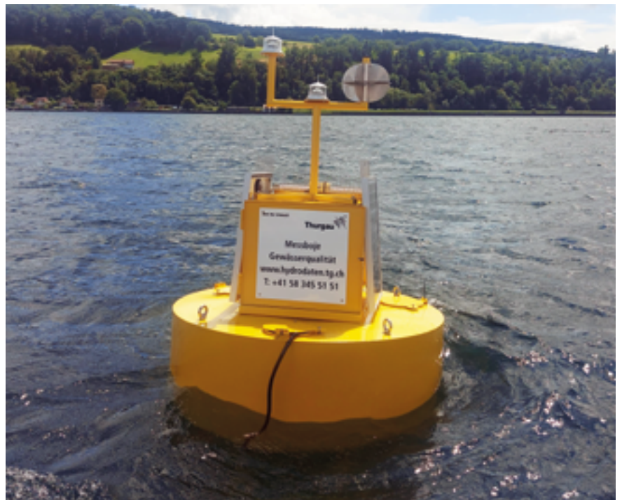
Die automatisierte Messboje im Untersee ist mit einer Multiparametersonde ausgerüstet. (Bild: Amt für Umwelt, Kanton Thurgau)
