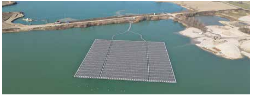
Schwimmende Photovoltaikanlage auf dem Baggersee eines Kieswerks in Leimersheim, Rheinland-Pfalz. (Bild: Fraunhofer ISE)
