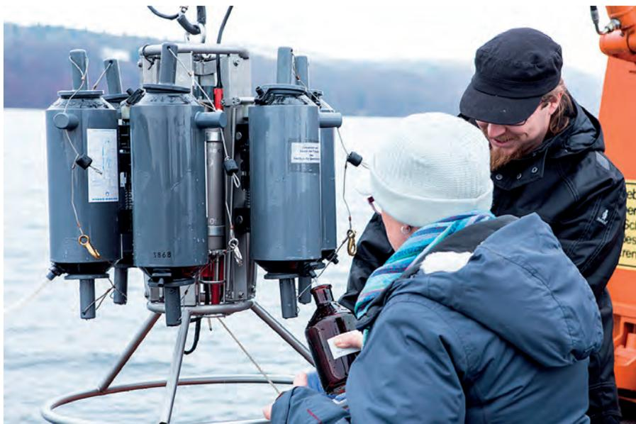
Mit einem Mehrfach-Probennehmer kann gezielt das Wasser aus einem unterseeischen Grundwasserzutritt entnommen und später im Labor analysiert werden. Foto: SeeZeichen
