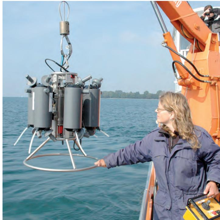
Entnahme von Wasserproben aus verschiedenen Tiefen Foto: Zintz
