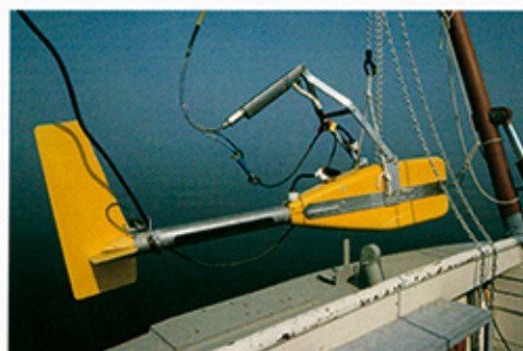
High-Tech-Arbeitsgerät, um den Seeboden zu kartieren und Wracks zu orten: der Sidescan.
